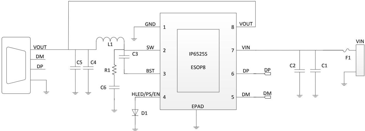
图 6 IP6525S 输出应用原理图
