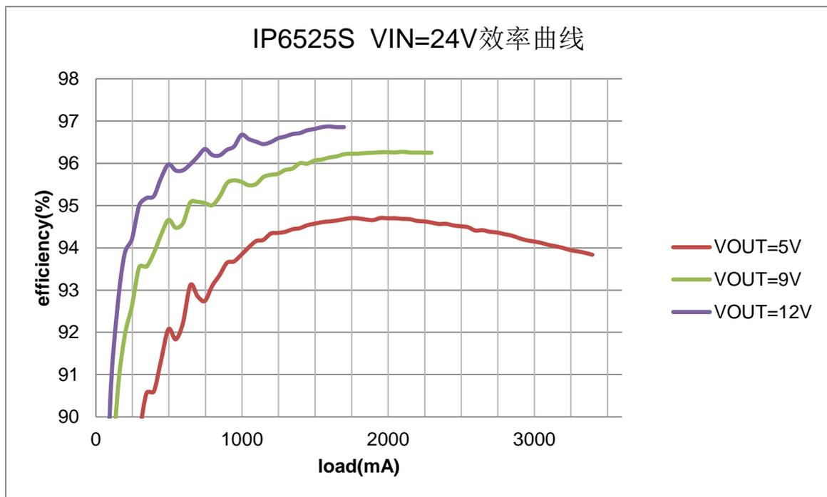
图 4 IP6525S VIN=24V 时的效率曲线图
