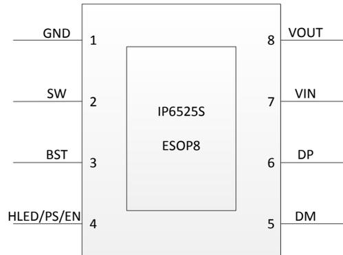
图 2 IP6525S 引脚图
