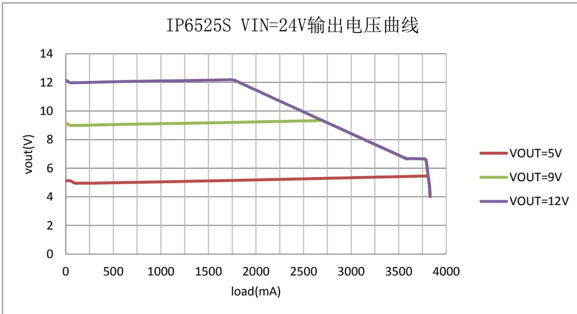
图 5 IP6525S 的输出电压和电流关系曲线
