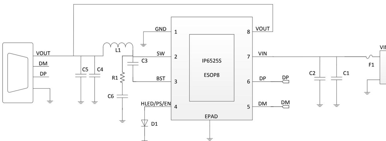
图 1 IP6525S 简化应用原理图
